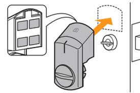
取り付ける際に、ドアのサムターンの回転の中心と、サムターンホルダーの回転の中心を合わせてください。
